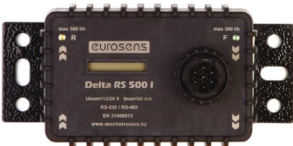
**Delta RS 500 I** – El caudalímetro de flujo diferencial de alto rendimiento para la instalación en motores diésel de alta potencia. La interfaz digital le permite conectar varios caudalímetros de flujo a un solo terminal de adquisición de datos. Recopilación de datos no solo sobre el consumo de combustible, sino también sobre los modos de funcionamiento del motor (versión con pantalla).
