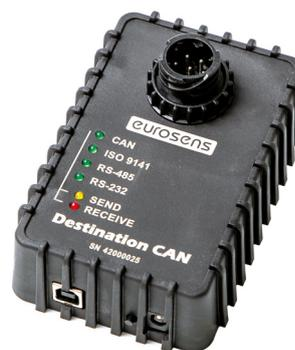
Los adaptadores **Eurosens Destination 02 Lite, 02, CAN** también se pueden usar para conectar cualquier hardware a través de RS232, RS485 (ambos son Destination 02), CAN (Destination CAN) al puerto USB de la computadora.
