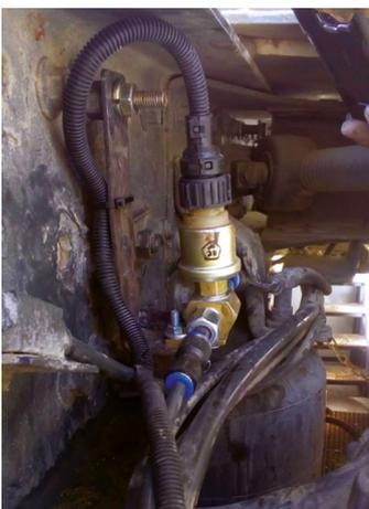
**Sensor DPS** se instala directamente en el circuito del sistema de suspensión y mide la presión en el elemento neumático. La presión medida es proporcional a la carga sobre el eje.
